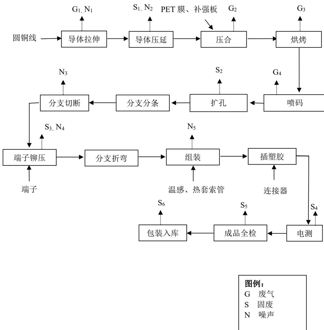
图 2-1 CCS 生产工艺流程图
